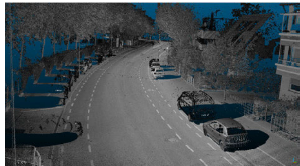
Abbildung 4: 3D-Punktwolke einer Straßenszene erzeugt aus Messdaten des CPS und der Trajektorie.
