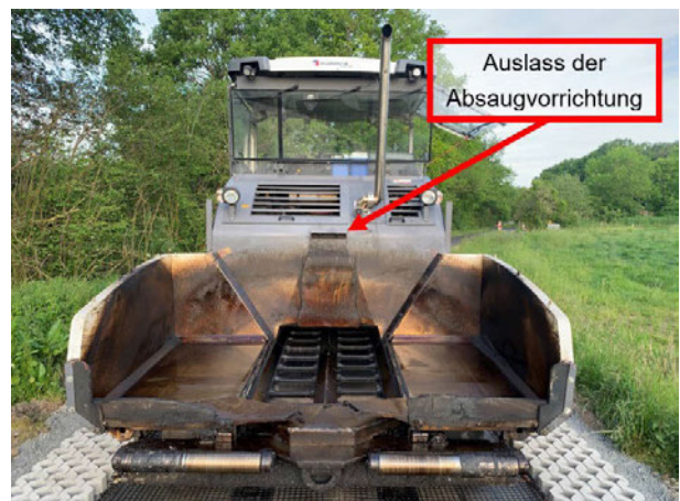
Abb. 6: Auslass der Absaugvorrichtung (ERD)
