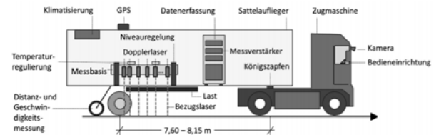
Abbildung 2: Prinzipskizze des Messfahrzeugs[9]
