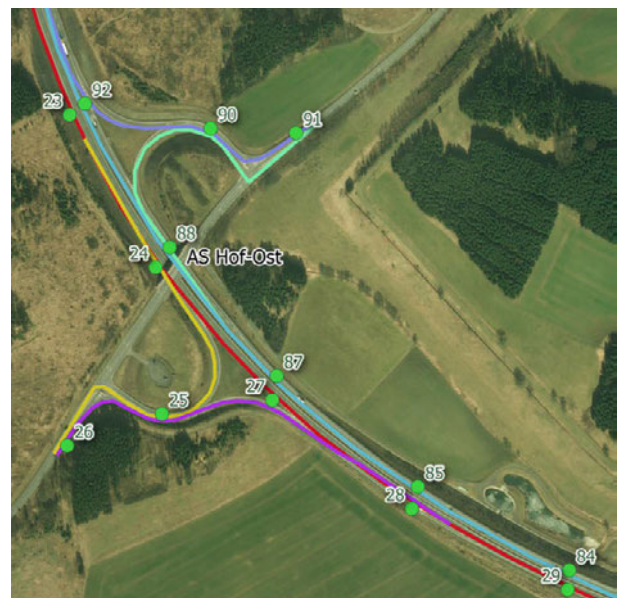
Abbildung 6: Die Verteilung der Passpunkte (grüne Punkte) entlang der Messstrecken (farbige Linien) richtet sich nach dem Streckenverlauf und GNSS-Qualität.
