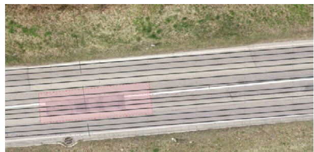
Bild 4: Abdeckung des Bestandes durch die Georadarbefahrung
