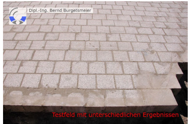
Vergleich herkömmliche Bauweise zu LTR-Verlegung – Pflaster-Terrazzo
