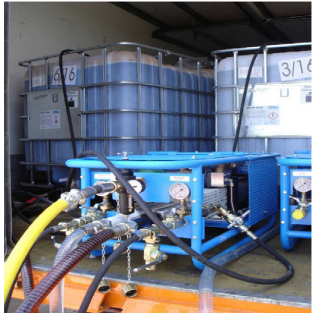
Bild 6: Mobile Injektionseinheit mit Kunstharzliefergebinden
