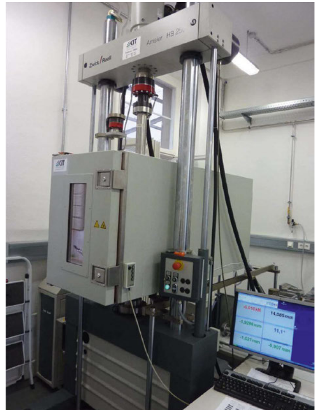
Servohydraulische Prüfanlage zur Durchführung von Spaltzug-Schwellversuchen © KIT
