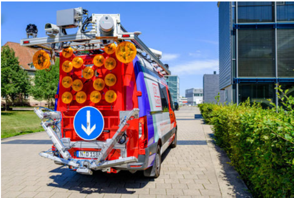
Abbildung 1: Messfahrzeug von hinten mit dem Sensoraufbau im oberen Bereich und den LEDs für die Ausleuchtung der Straße im unteren Bereich.
