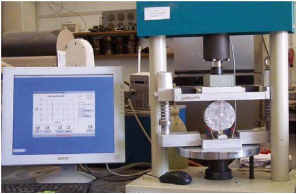
Spaltzugschwellversuch Bohrkern Beton ©ABPI
