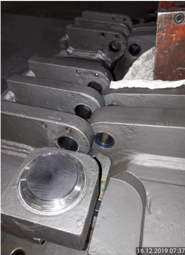
[10] Neue Buchsen und Gleiteinheit
