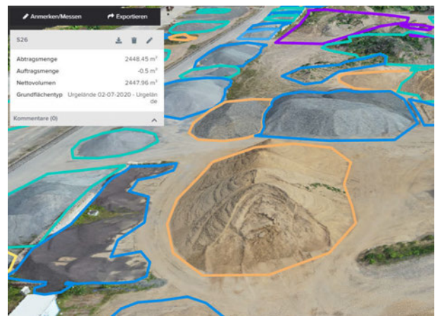
Abbildung 14: Volumenberechnung von Materialhalden Quelle: AVUS.DIGITAL, VIA IMC GmbH
