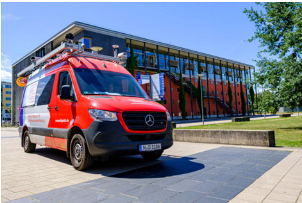
Abbildung 2: Messfahrzeug von vorne mit Sensoraufbau im oberen Bereich. Nicht sichtbar ist das System für die Erfassung der Längsebenheit unterhalb des Fahrzeuges.
