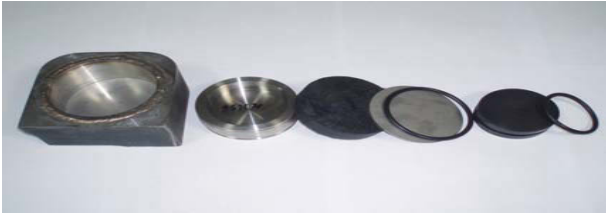
[9] Gleitelement UHMWPE, Lagergehäuse; Dichtring Die alten Gelenkbuchsen und -bolzen waren abgängig. Die Gelenkverbindungen wurden komplett erneuert.
