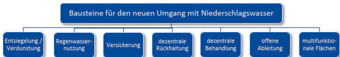
Abb. 3: Umgang mit Niederschlagswasser [Quelle: eigene Darstellung]
