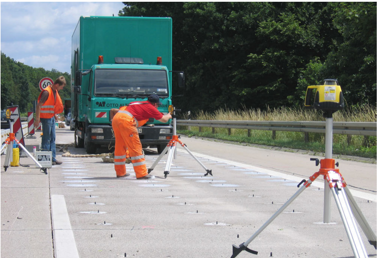
Bild 3: Lageüberwachung mit Lasermesstechnik und Stufenmessgerät
