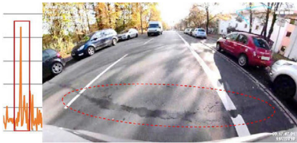
Bild 4: einzelner Messausschlag durch vergossenen Querriss [1]
