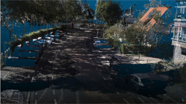
Abbildung 5: 3D-Punktwolke der gleichen Szene wie in Abbildung 4, wobei die Punkte eingefärbt sind anhand der Bilder der Umgebungskameras.
