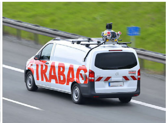
Abbildung 2, links: Das Trimble MX9 Mobile Mapping System mit zwei Laserscannern (a), Fahrwegkamera (b), 360 Grad Panoramakamera (c), Frontalkameras (d) und GNSS-Empfänger (e).
