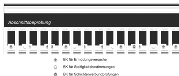
Bohrkernentnahmeplan RSO Asphalt [15]
